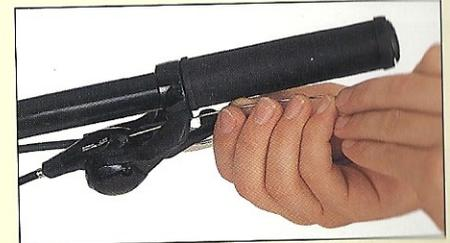
apenas pela actuação, por meio de uma alavanca que o ciclista colocava manualmente na posição desejada. Muitos sistemas incluem ainda esse processo, mas a norma das alavancas modernamente são alavancas indexadas. Os desviadores modernos são fáceis de usar mas têm de ser cuidadosamente ajustados. O movimento do desviador tem de ser limitado, para que a corrente não ultrapasse os carretos extremos.
