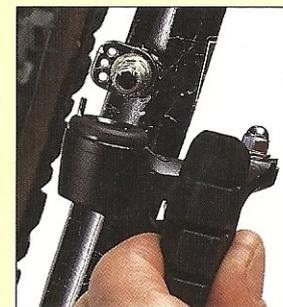
**TENSÃO DA MOLA** A escolha do orifício no braço do travão determina a tensão da mola. Em condições de tempo húmido use maior tensão.
